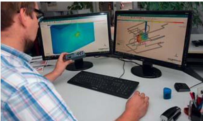
Marcus Schilling: „Simuliert wurde, wie sich das Bauteil durch gezielte Temperierung im Werkzeug verhält.“ Die Simulationsergebnisse, die mit T-Box gerechnet wurden, zeigten den richtigen Temperierungsansatz auf.
